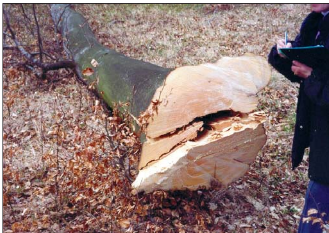
5. kép. A nedvességkülönbség okozta belső feszültségek miatti hasadás az alsó szelvényen
