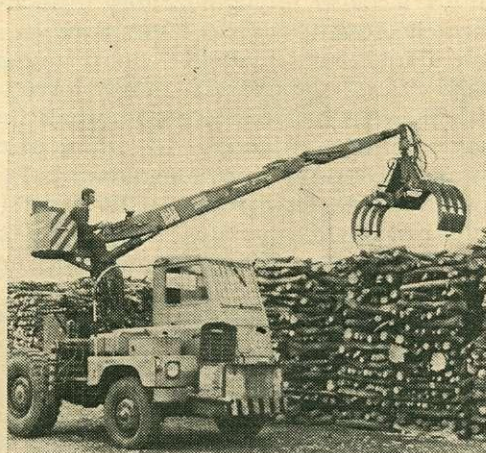
2. ábra. Dömpér alvázra szerelt HIAB-daru munka közben
