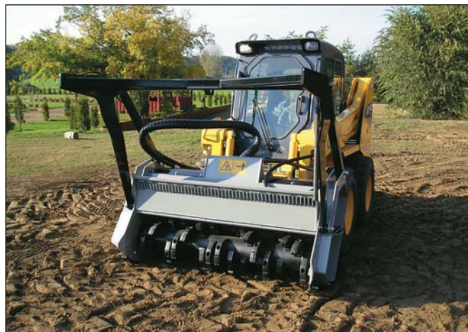
GEHL kompaktrakodó, bozótirtó szereléssel felszerelve
