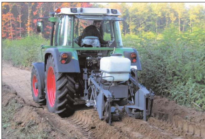
FIG-01 forgókaros injektológép (fejlesztette: NYÍRERDŐ Zrt., KEFAG Zrt. és a Nyugat-magyarországi Egyetem)
