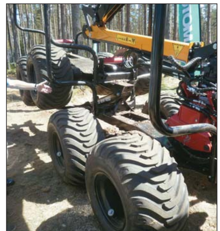
13. ábra: Malwa forwarder összecsucskható rakfelülete (Fotó: Horváth Attila László)
