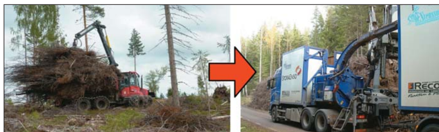
7. ábra: Chipper truck rendszer (Fotók: Dimitris Athanassiadis)
