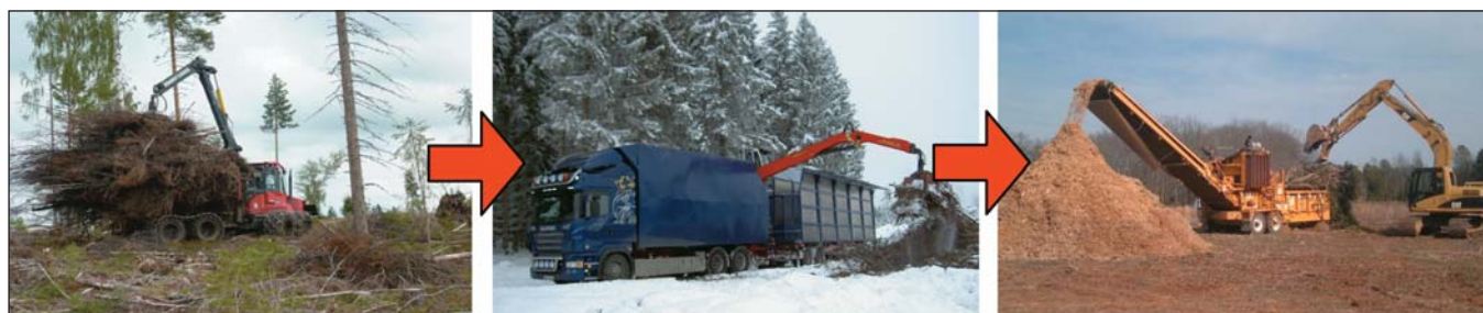
6. ábra: Loader truck rendszer (Fotók: Dimitris Athanassiadis)
