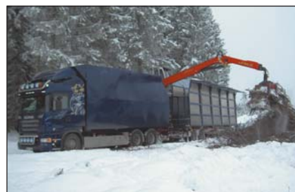
3. ábra: Vágástéri melléktermék szállítása kamionnal (szállítási kapacitása 22 tonna) (Fotó: Peter Sondelius)
