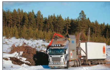
2. ábra: Aprító-kamion (Chipper-truck), 29 tonna szállítási kapacitással (Fotó: Peter Sondelius)
