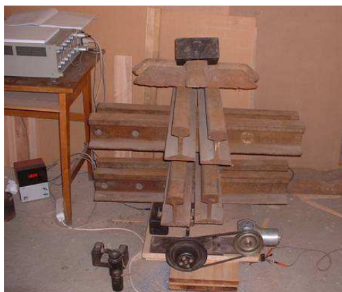
3. ábra – Munkadarab elmozdítás raszterasztalon, súlyterhelésnél
