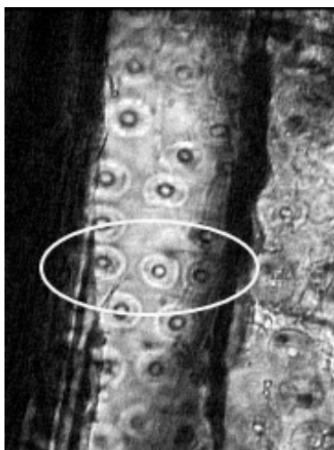
9. ábra – Egy sorban hármásával álló udvaros gödörkék hossztracheidában (11. minta) Nagyítás: 400×
