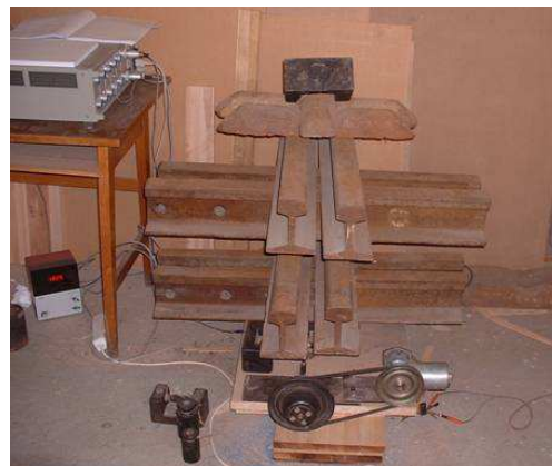
3. ábra – Munkadarab elmozdítás raszterasztalon, súlyterhelésnél
