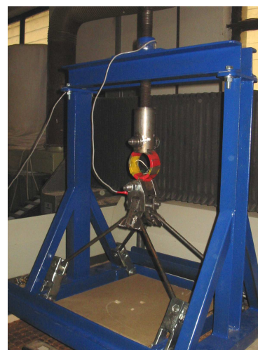
4. ábra – Munkadarab leszakító berendezés mérő gyűrűvel
