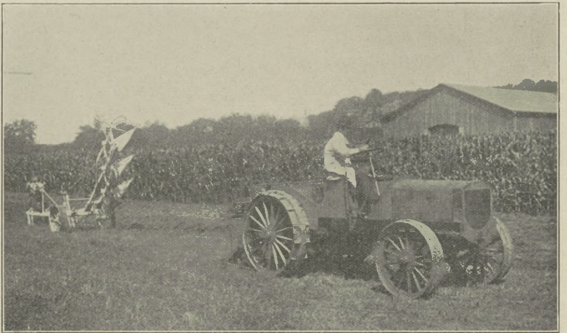
6. ábra. A Bajacz-motor munkában, húzva a vilkenő ekét.
